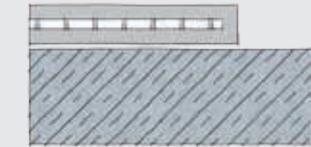
Der abzudichtende Bereich ist immer mit einem Klebeband einzugrenzen. Dies führt zu einem sauberen Arbeitsergebnis und ermöglicht die Kontrolle einer gleichmäßigen Schichtstärke. Hierbei sollte jeweils am Ende der Abdichtung ein vliesfreier Bereich von 5–10 mm eingehalten werden. (Zu weites über die Vliesarmierung Arbeiten oder eine zu hohe Schichtstärke kann dazu führen, dass sich der nicht armierte Bereich ablöst.)
