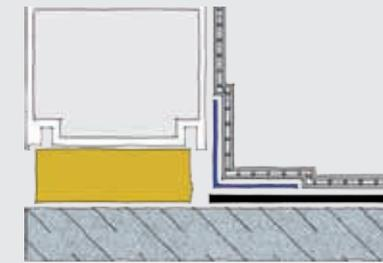
Um zu verhindern, dass ALSAN Flashing quadro z. B. in Türanschlüsse oder Dämmstofflagen eindringt, sind die Übergangsbereiche mit einem Steinband zu entkoppeln.
