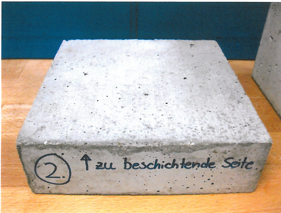
Bild 1 Prüfkörper vor Auftrag des redstone - Spritzbewurf
