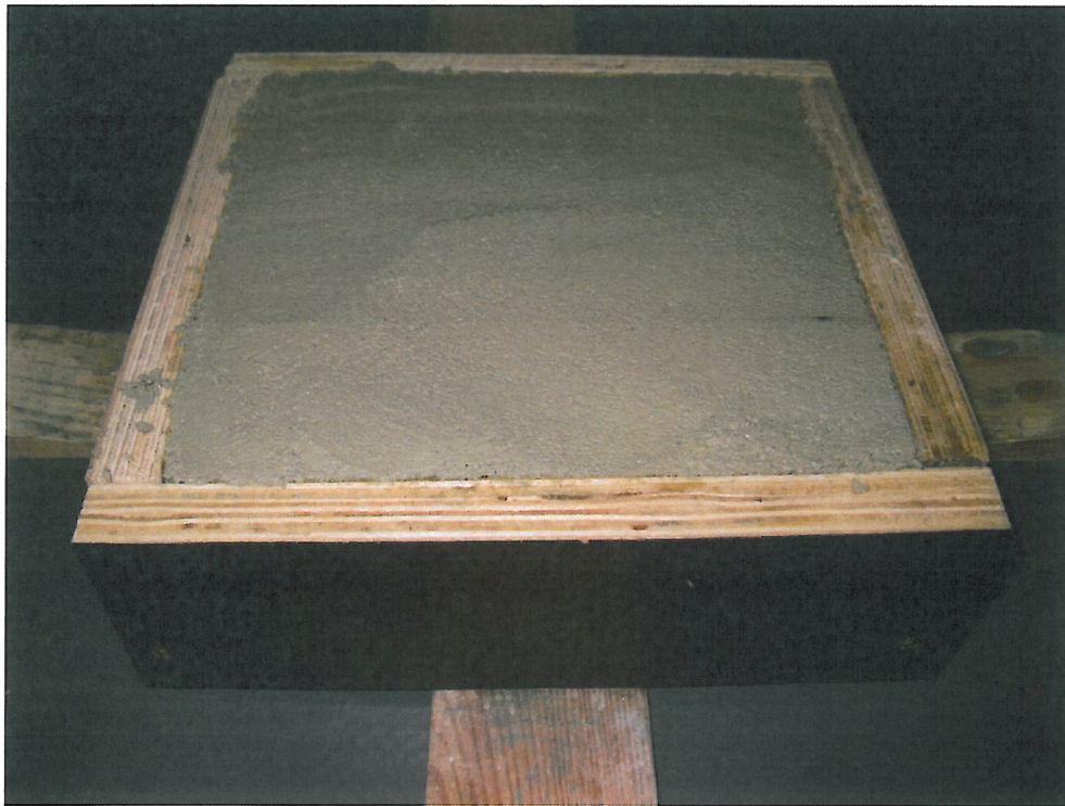
Bild 3 Prüfkörper nach dem Auftrag des redstone - Sperrputz
