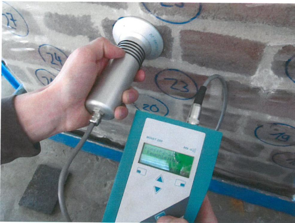
Bild 5 Messprinzip Feuchtemessungen mit Mikrowellenfeuchtemessgerät
