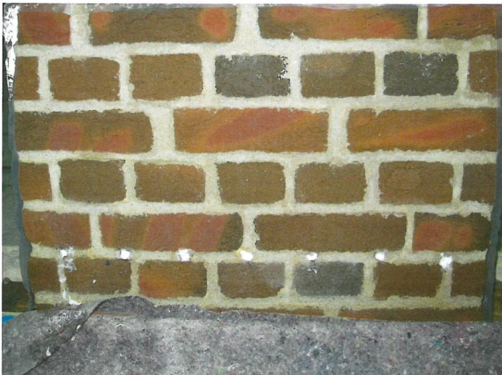
Bild 4 mit *Secco Horizontal Sperre* applizierter Prüfkörper vor dem Verschluss der Bohrlöcher
